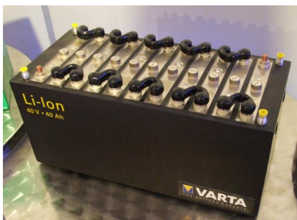
Bateria akumulatorów litowo – jonowych
