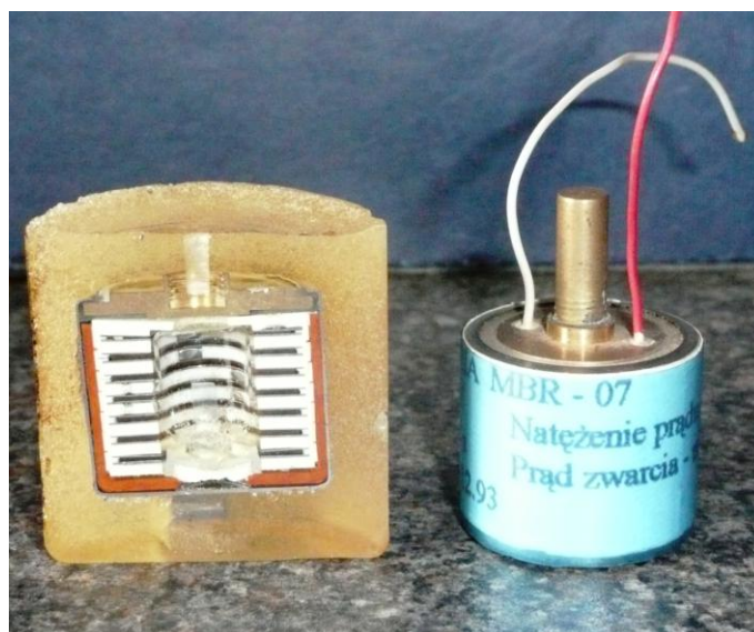
Przekrój baterii MBR – 07, bateria MBR – 07
